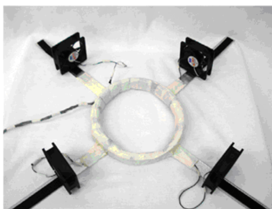
Figura 5: Estrutura em alumínio com os ventiladores fixados.
