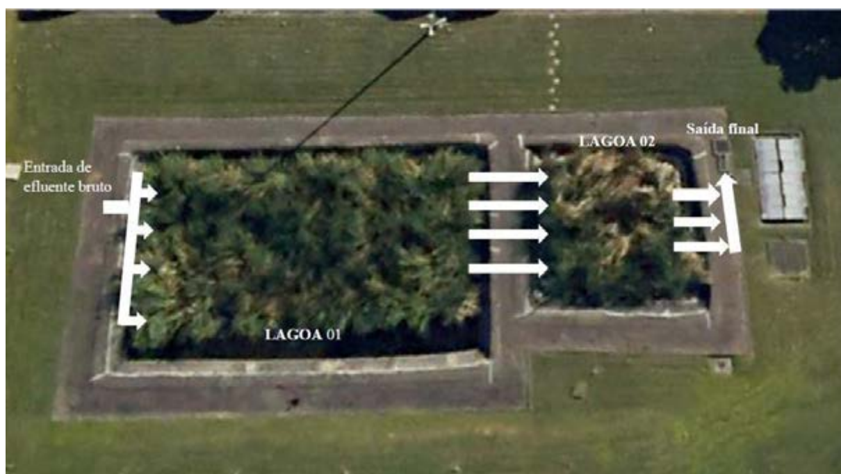
Figura 2. Fluxograma da estação de tratamento de efluentes condições original. As setas indicam o fluxo do efluente desde a entrada na Lagoa 1 passando para lagoa 2 e sendo conduzido para a saída final. Fonte: Elaborado pela autora, imagem Google Earth, 2024.
