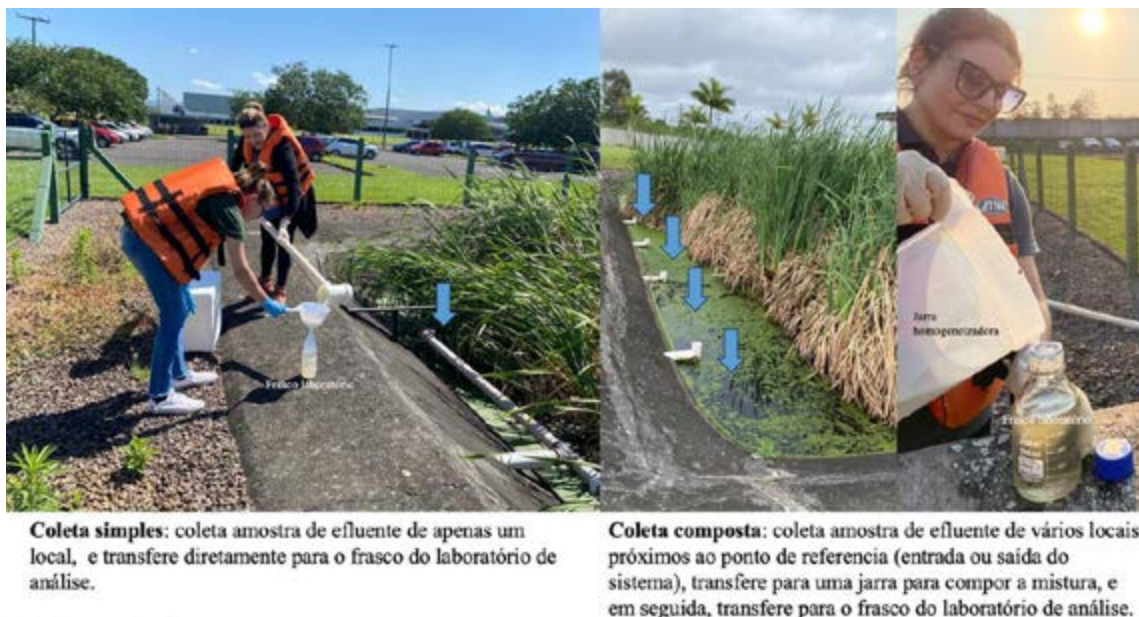
Figura 38 - Ilustração do método de coleta simples e coleta composta.
