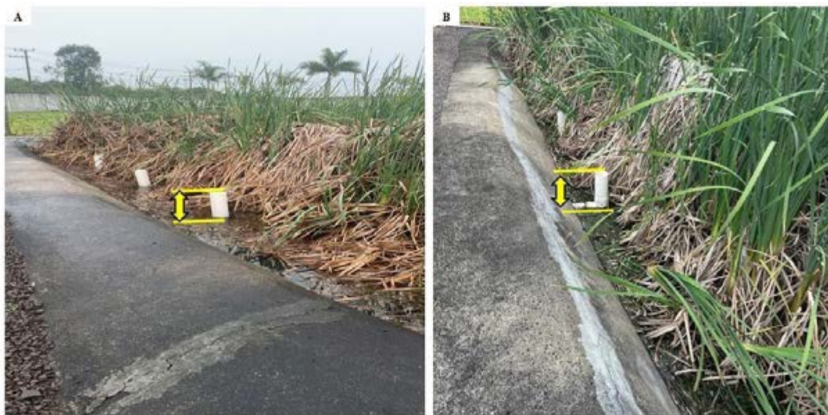
Figura 9. (A) Elevação do volume da L2, após transferência de efluente da L1, com o objetivo de aumentar a vazão no sistema e estabelecer o fluxo hidráulico. (B) Redução significativa do volume de efluente na Lagoa 2, após 36 horas da suspensão do bombeamento, mesmo com a continuidade do aporte de efluente bruto na entrada do sistema. Foto: Juliana Figura da Rosa.
