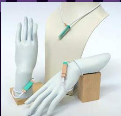
Maptic é um sistema de dispositivos sensíveis e portáteis para deficientes visuais, que se conectam através de um aplicativo de celular controlado por voz que, ao utilizar o GPS do seu smartphone, direcionará o usuário através de uma série de vibrações do lado esquerdo ou direito do corpo, mostrando em que momento e em qual direção ele deve se mover. O sistema permite que o usuário selecione e possa adaptar o dispositivo às suas necessidades.
