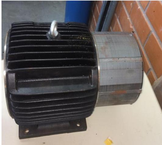
A bancada de teste em fase de ajustes terá a medição da potência mecânica fornecida ao gerador feita por um dinamômetro. O dinamômetro ficar acoplado entre a saída do motor (eixo) e a entrada do gerador (eixo), assim a potência consumida pelo gerador será medida e comparada com a potência elétrica fornecida pelo gerador à carga. A razão entre a potência fornecida pela potência consumida pelo gerador dará o seu rendimento. O motor elétrico por sua vez será acionado por um inversor de frequência.
