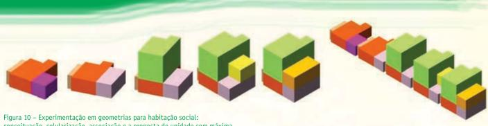
Figura 10 – Experimentação em geometrias para habitação social: conceituação, celularização, associação e a proposta de unidade com máxima compactação e flexibilidade de arranjo - Análise: Depthmap® (KRAKE, 2007)
