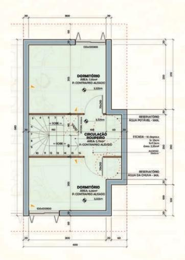
Figura 16 - Planta baixa do pavimento superior (GIOVENARDI E MARQUES, 2007)
