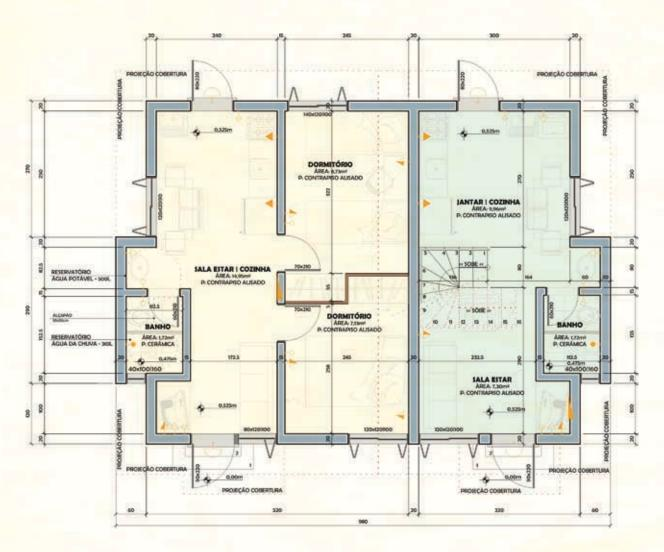
Figura 15 - Planta baixa do pavimento térreo das casas geminadas. À direita casa de 2 pavimentos (GIOVENARDI E MARQUES, 2007)
