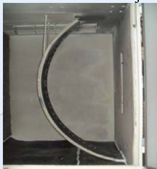
Figura 1- Vista da parte interna da câmara de jateamento e do semicírculo
