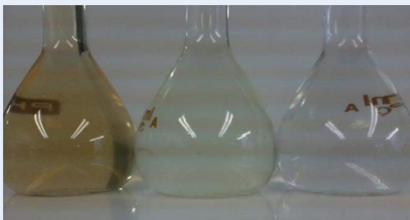
Figura 1: aspecto visual da amostra bruta (esquerda) tratada por ozônio (centro) e após polimento com carvão ativado (direita) (foto: autor).
