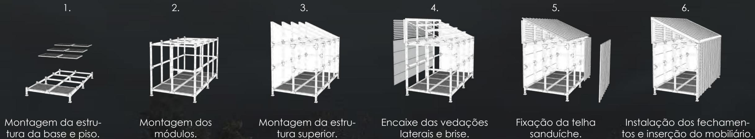
Os módulos principais são montados apenas utilizando pinos de encaixe nas barras como meio de fixação. Não há necessidade de soldas ou fixações complexas.
