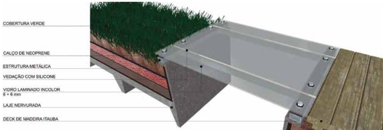
Imagem 44- Detalhe em 3D da cobertura. Fonte: Detalhe realizado pela acadêmica
