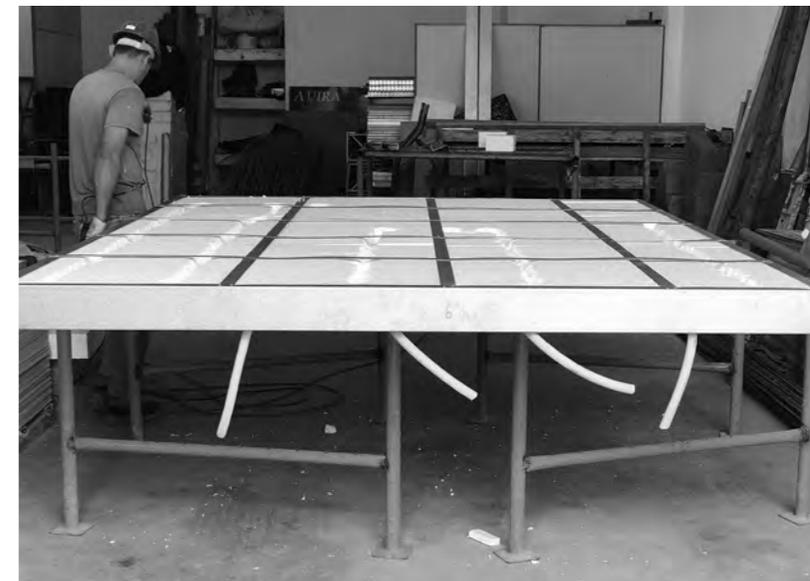
Figura 7(Acima) - Módulo de parede em aço galvanizado e núcleo em EPS.
