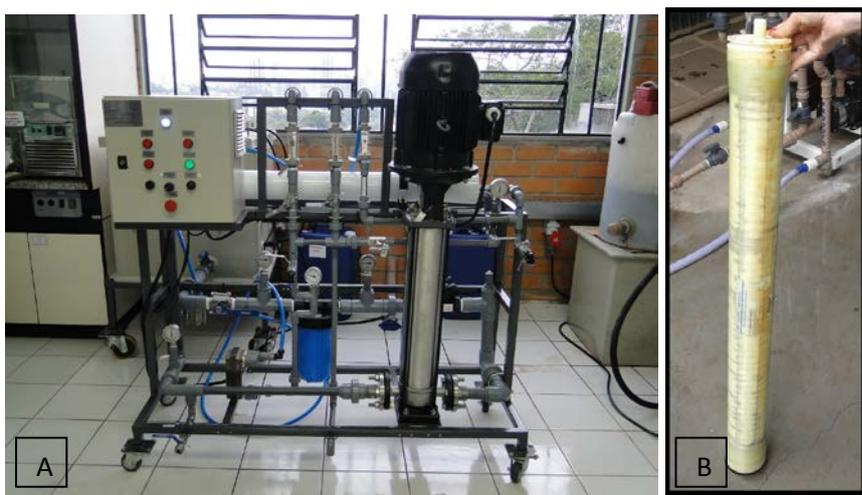
**Figura 1 - (A) Equipamento de OI. (B) Membrana de OI**
