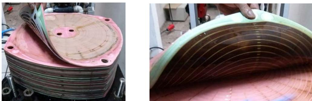
**Figura 3. Membranas incrustadas – vista geral e detalhe**
