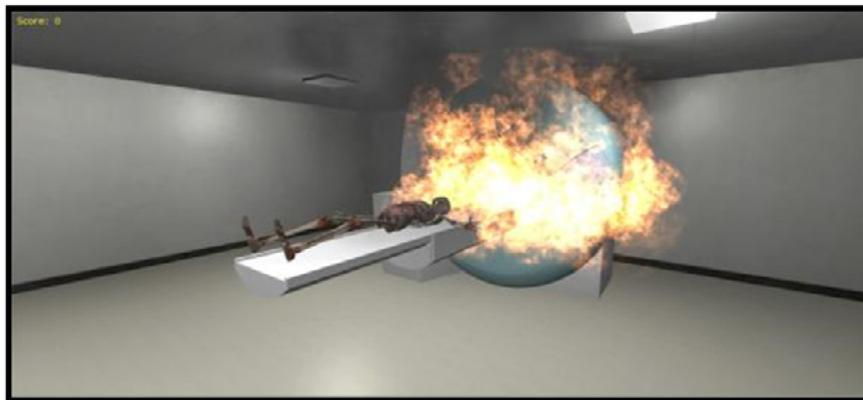
Ilustración 14 - Explosión producida por la atracción de un tanque de oxígeno al centro del magneto.
