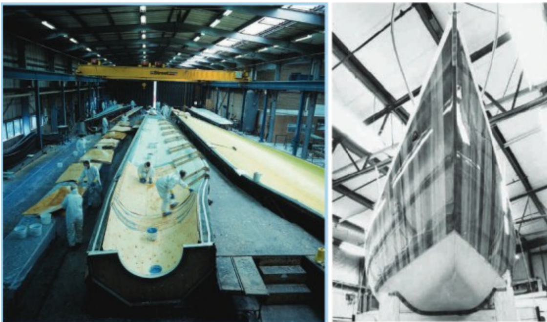
Figura 12 – A esquerda, camada de madeira balsa sendo aplicada no molde de pá de material compósito, a direita iate dos anos 70 feito de compósito madeira-resina. Fonte: HANCOCK, 2014.
