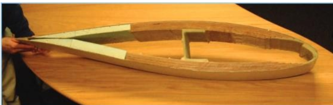
Figura 13 - Perfil de asa contendo núcleo em madeira balsa (plywood) e camada externa em fibra de vidro. Fonte: HANCOCK, 2014.
