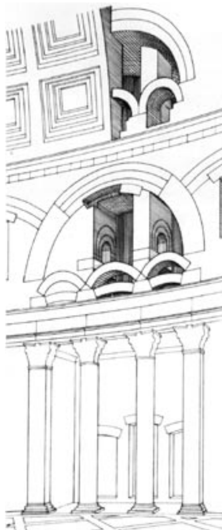
Figura 12: diagrama estrutural e a sucessão de arcos. Fonte: MACDONALD, 1976.
